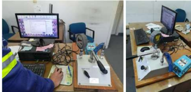
Calibración de sensores de presión
