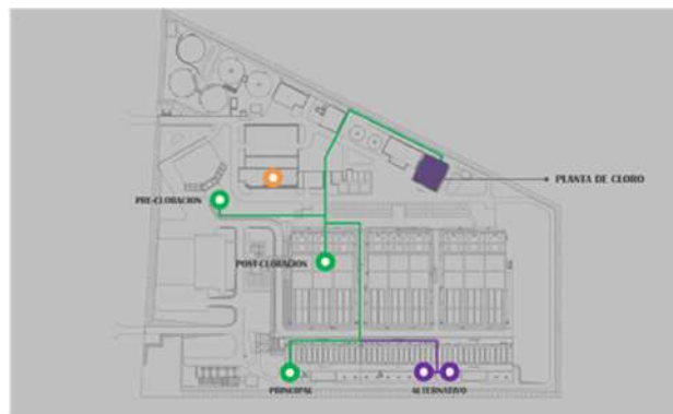
Puntos de dosificación de cloro
