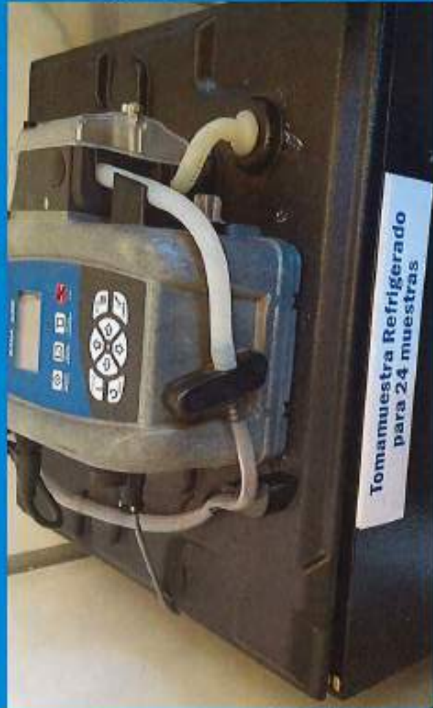
Vista de arriba: Sistema de Captura de toma de muestras automático marca Hach SIGMA SD 900 Fecha de relevamiento: 4/08/2017
